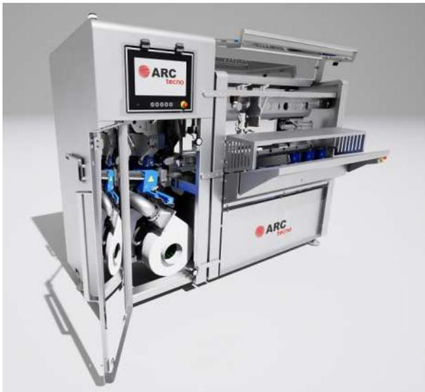
La máquina peladora está compuesta por dos zonas de extracción. Una, donde caen en un cajón las puntas con el primer clip y su cuerda y la otra donde se extrae la tripa, esta sale a través de un tubo de expulsión por aire.
